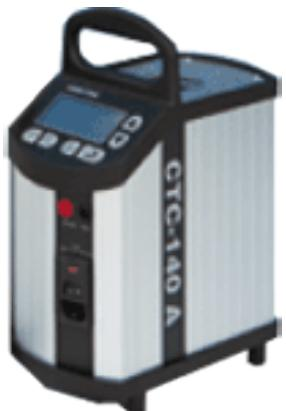
Calibrados con equipo AMETEK mod. CTC-140 a rango de -30 °C a 140 °C, con un error de calibración del orden de  $\pm 0.02$  °C.
